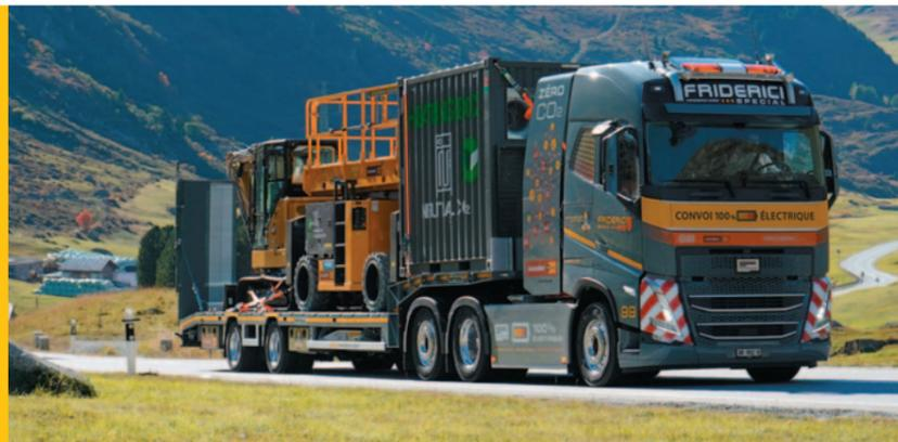
données techniques, le Futuricum FH Semi 40E afficherait sur la balance 13,5 t, dont 5,44 t rien que pour les batteries lithium-ion. Celles-ci se rechargent à 80 % en moins de 2 heures sur un superchargeur de 350 kW et en 4 heures sur une borne de 150 kW.
