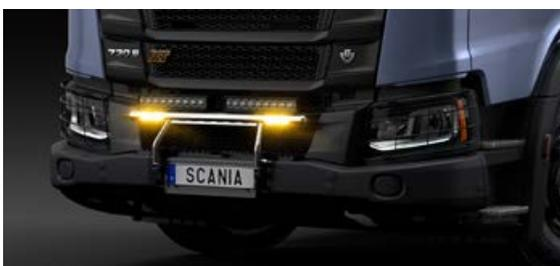
**Rampe avant/marchepied XT repliable, avec clignotants stroboscopiques**
