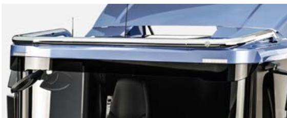
**Rampe de feux de toit « large » pour toit bas, sans LED**
