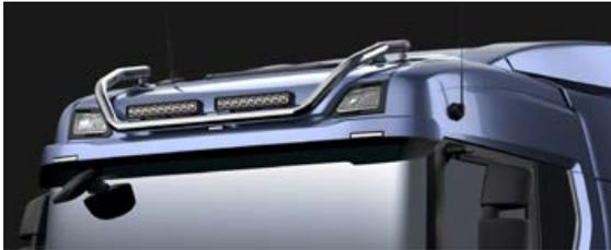
**Rampe de feux Scania pour toit normal, courte, sans LED**
