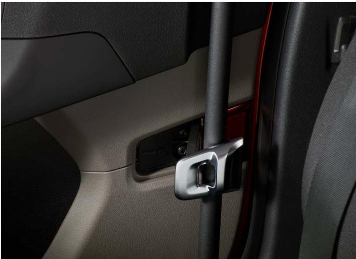
**Verrou de nuit : serrure de porte de sécurité mécanique pour les séries NTG**
