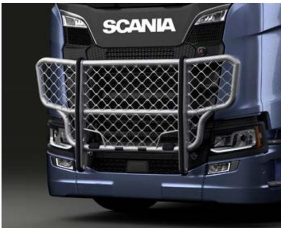
**Protection avant pour rampe de feux, kit Trux Off-road Airflow**
