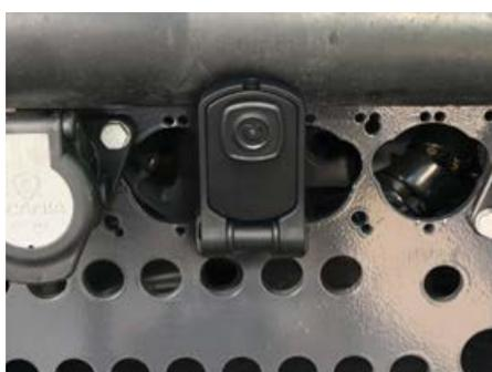
Dessin de configuration d'extension avec caméra HD de vue arrière (porteurs uniquement)
