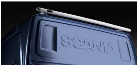
**Kit de rampes de feux de toit, à l'arrière de l'Airflow**
