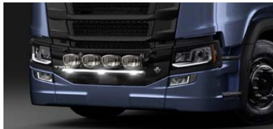
**Rampe de feux avant Scania, droite, avec LED**
