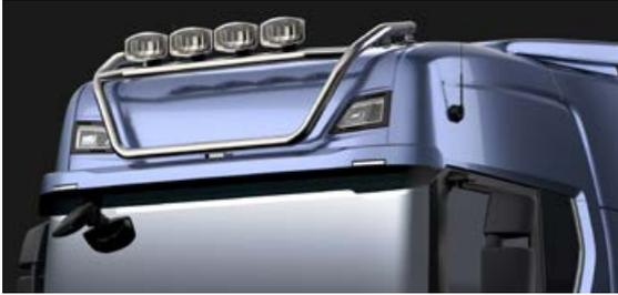
**Rampe de feux Scania pour pavillon élevé, courte, avec supports de lampe en position haute**
