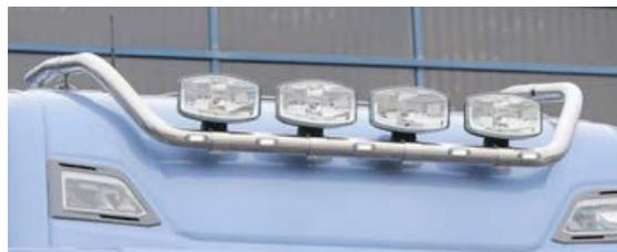
**Rampe de feux de toit « supérieure » pour toit normal ou élevé, avec LED**
