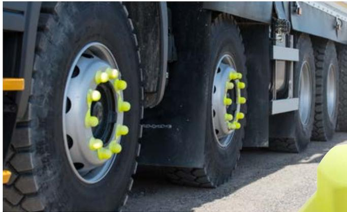
**Témoin d'écrou de roue desserré**
