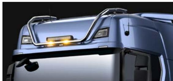
**Rampe de feux Scania pour toit haut, longue, avec clignotants stroboscopiques à LED**
