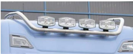
**Rampe de feux de toit « supérieure » pour toit normal ou élevé, sans LED**
