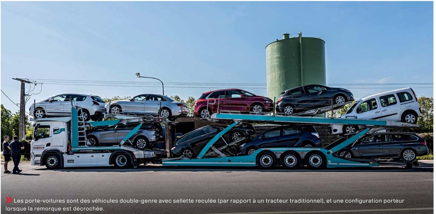
» Les porte-voitures sont des véhicules double-genre avec sellette reculée (par rapport à un tracteur traditionnel), et une configuration porteur lorsque la remorque est décrochée.
