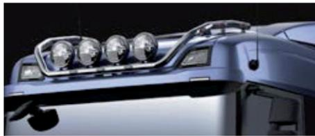
**Kit de longue rampe de feux, avec LED, pour toit normal et 4 x lampes Cibié**
