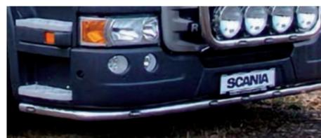
**Tuyau avant avec LED, séries G et R, pare-chocs bas, AM 2014-**
