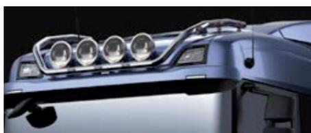
**Kit de longue rampe de feux, avec LED, pour toit normal et 4 x lampes Hella Luminator**
