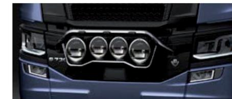
**Kit de rampe de feux avant, avec LED + 4 x lampes Luminator Chrome**
