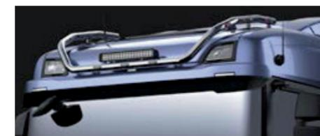
**Rampe de feux Scania pour toit normal, longue, avec LED**
