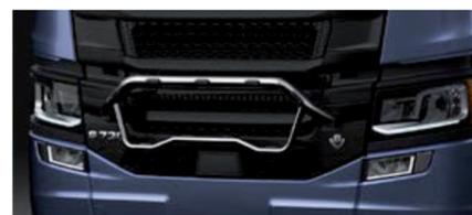
**Rampe de feux avant Scania, avec LED**
